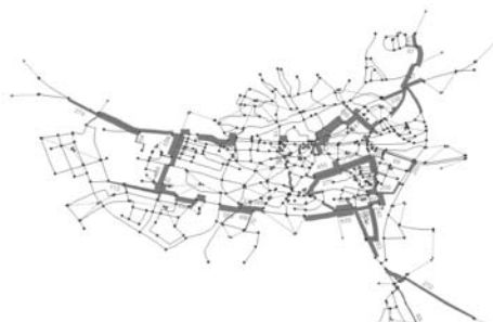
Slika 2: Brojne vrijednosti za PA na krstosnici, obračunati u VISUM, predstavljeni na deonicama
