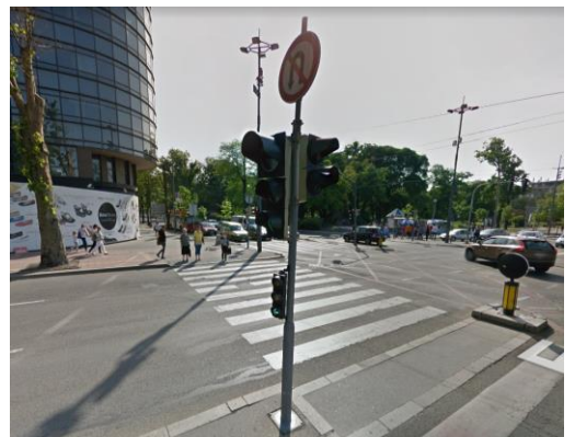
Slika 26: Semafor ponavljač za vozača prvog vozila u redu ispred semafora
