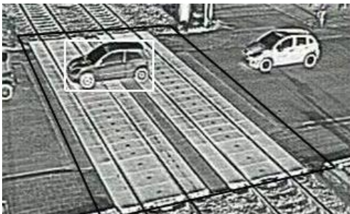
Slika 15: Način detektovanja vozila uz pomoć termalnih kamera
