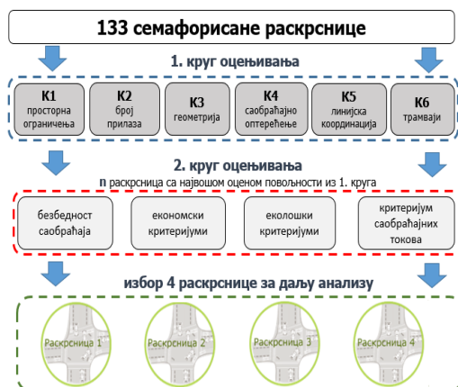
Slika 6: Algoritam primene kriterijuma za izbor raskrsnica [1]
