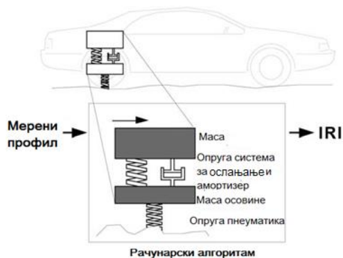
Слика 4: Модел „четвртине аутомобила“ [1]
