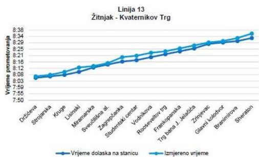
Grafikon 2: Usporedba vremena putovanja dobivenih simulacijom i stvarno izmjenjenog vremena za liniju 13 smjer Žitnjak – Kvaternikov trg
