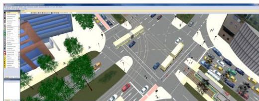
Slika 10: Multimodalna simulacija složene raskrsnice, Karlsruhe, Nemačka. [1]
