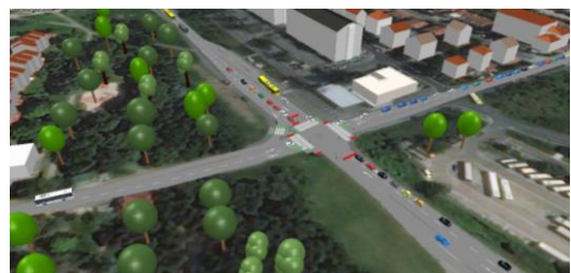
Slika 18: PTV Vissim - Simulacija saobraćaja na raskrsnici Trgoavačka-Jablanička (semafor). [5]
