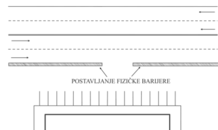
Slika 6: Postavljanje barijera na podužnim pristupima [2]
